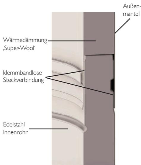
Die einzelnen **PERMETER SMOOTH**-Elemente werden durch die Steckverbindung einfach und optisch ansprechend, klemmbandlos zusammengefügt.
